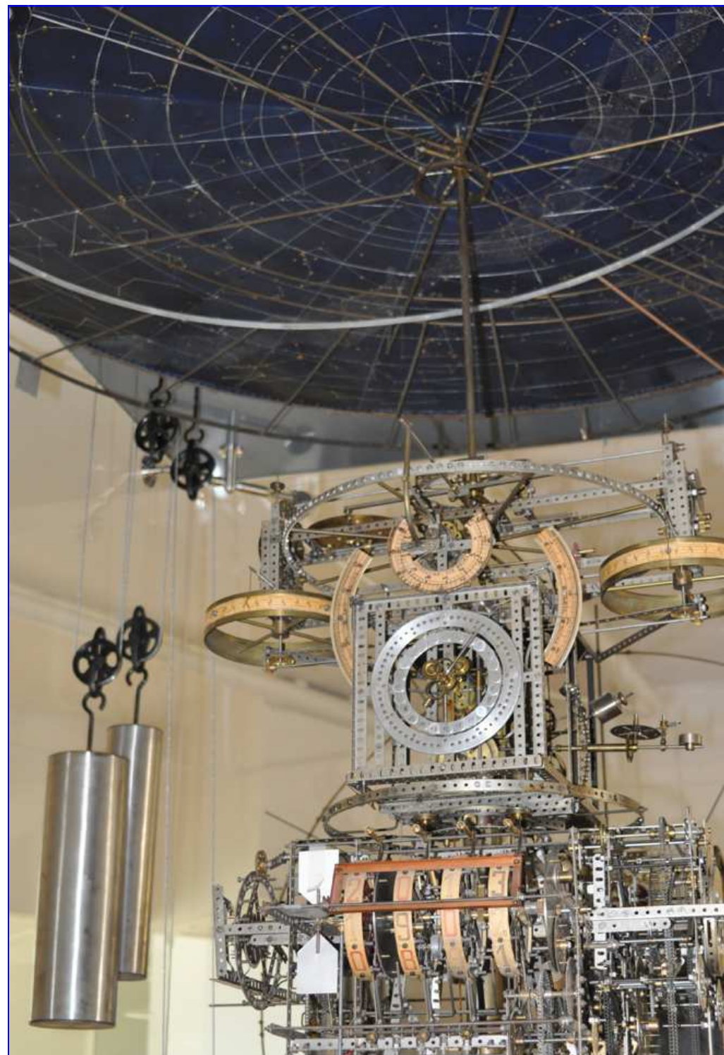
Le système de poids et le treuil de remontage ont été adaptés à la nouvelle présentation.
